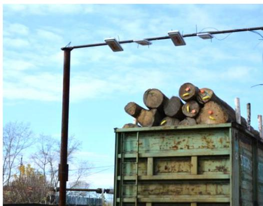
Рис. 3. Определение считываемости информации с радиочастотных меток, закрепленных на древесине, загруженной в железнодорожный полувагон
