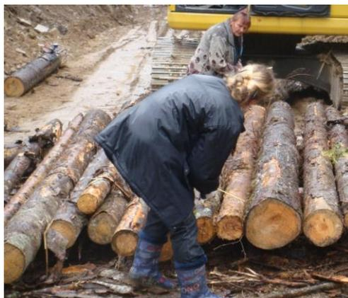
Рис. 2. Определения объема заготовленной древесины по методу конечных сечений в Сукпайском лесничестве Хабаровского края
