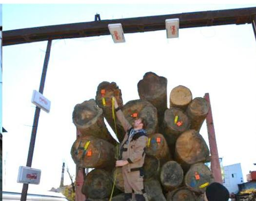
Рис. 4. Определение считываемости информации с радиочастотных меток, закрепленных на древесине, загруженной в автолесовоз
